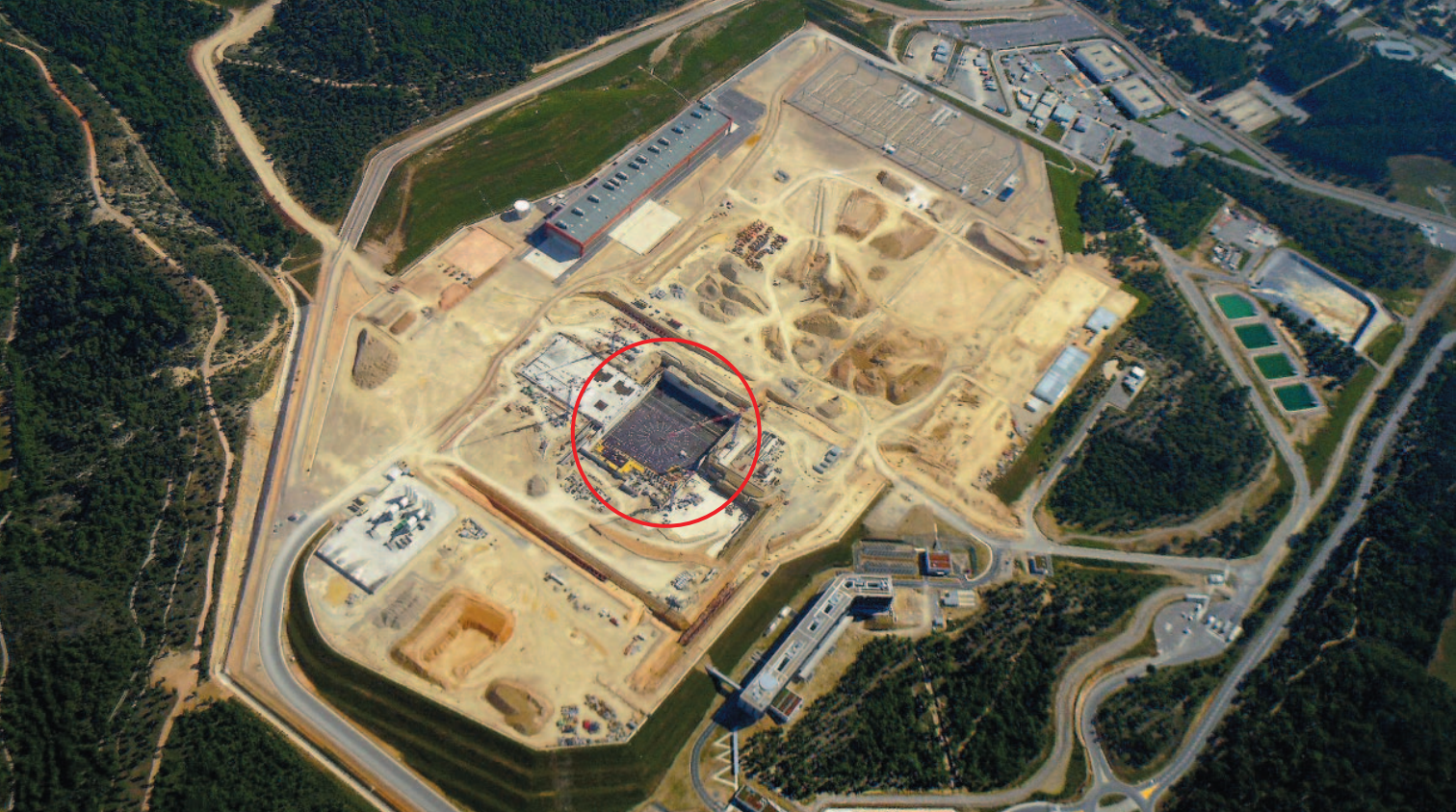
Выделено красным: сейсмоустойчивый фундамент реакторного комплекса ITER
